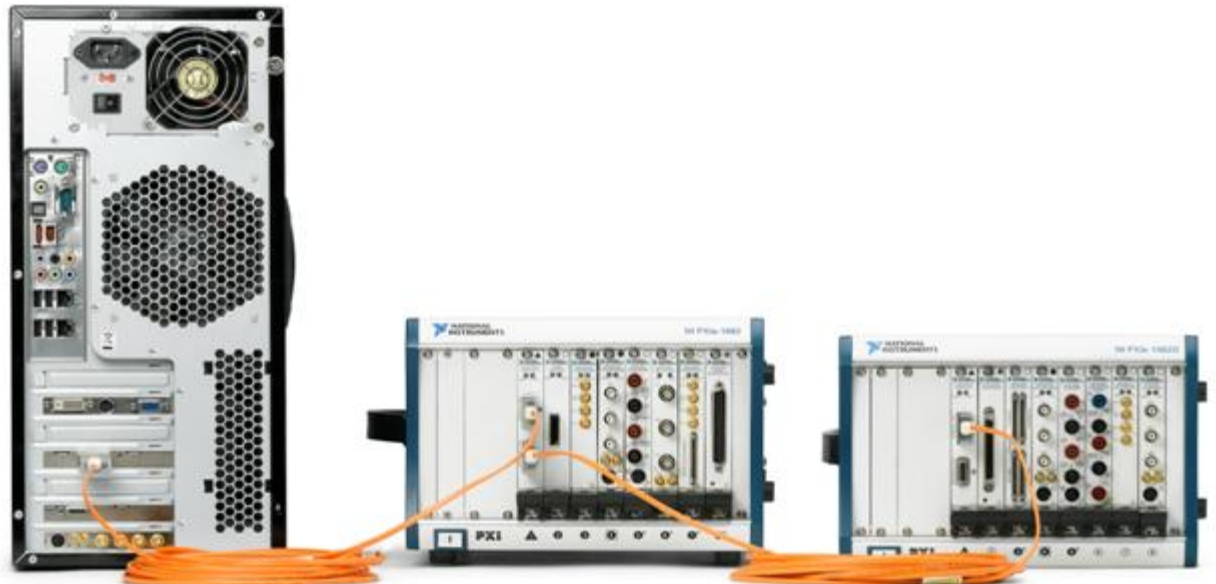
Рисунок 8. С MXI-Express вы можете управлять системами PXI при помощи шины PCI Express ноутбука, персонального компьютера или сервера.
